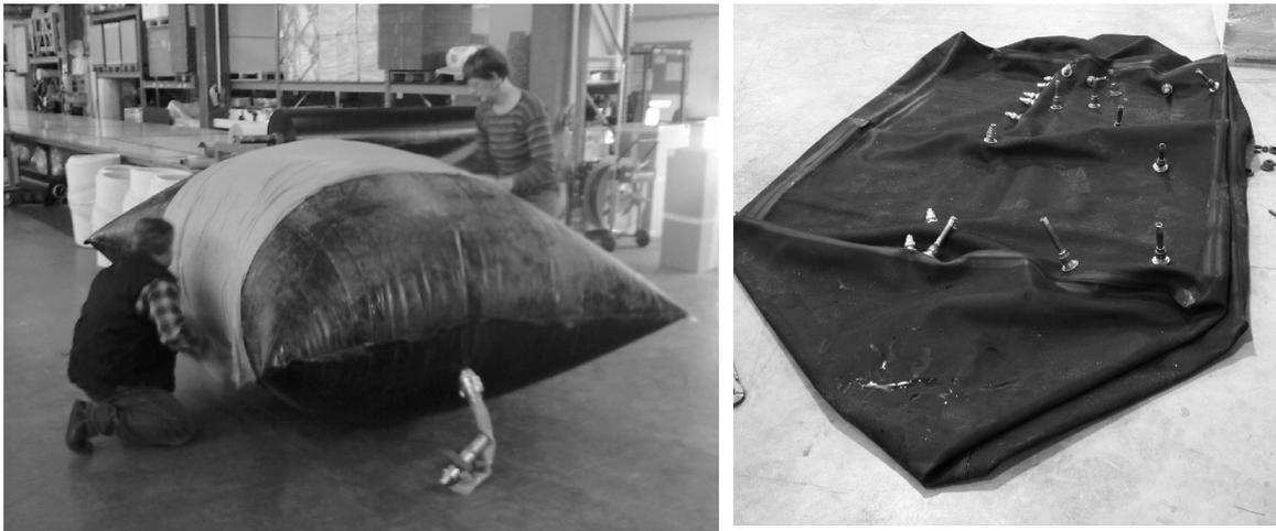
Abb. 2: Flexibler Kautschukbehälter bei einer Dichtheitsprüfung (links), Behälter mit 5 m<sup>3</sup> Speichervolumen und Anschlüssen (rechts)
